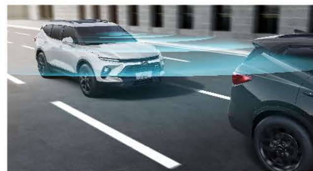
FCA前方碰撞预警+AEB碰撞缓解制动
