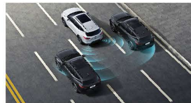
SBZA侧盲区报警+LCA车道变更辅助
